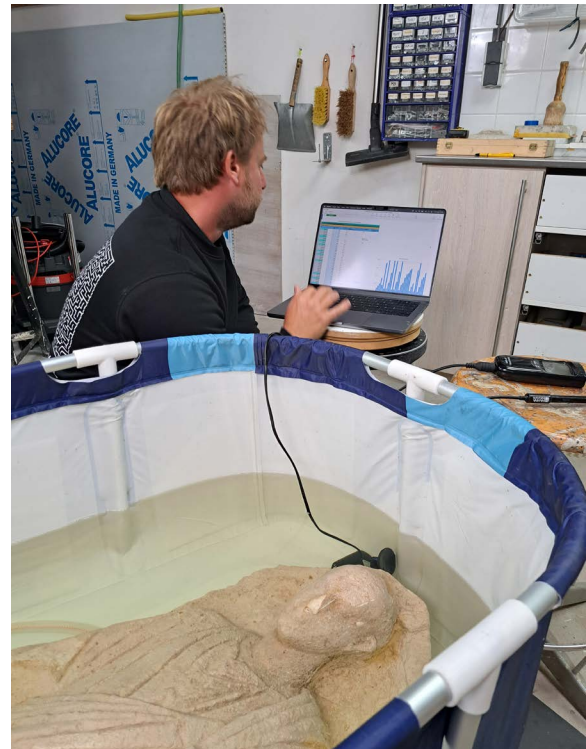
Restaurator Nicolas Verhulst meet de zoutconcentratie in het water (foto Allard Pierson).
